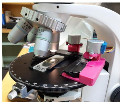
Испытание работы прототипа на микроскопе Биомед 5П
