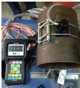
Система измерения скорости коррозии на стендовых испытаниях.
