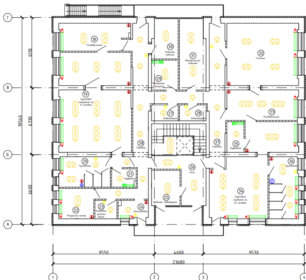
Рис. 2. Вариант расстановки элементов беспроводной системы «Умное здание» на этаже 2
