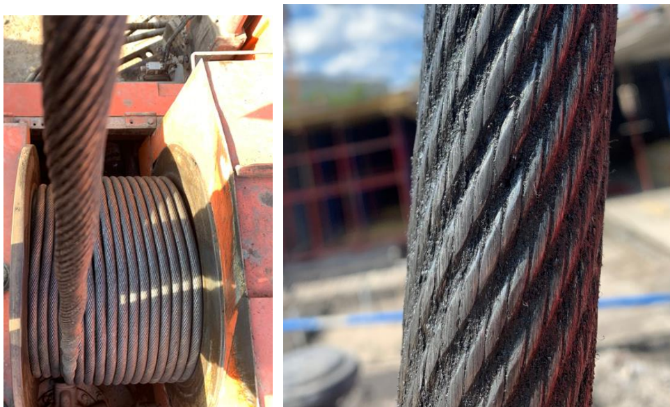
Рис. 4. Грузовой канат после выбраковки в системе с «клиновой муфтой» (слева), грузовой канат после выбраковки с наконечником типа END-STOP (справа)
