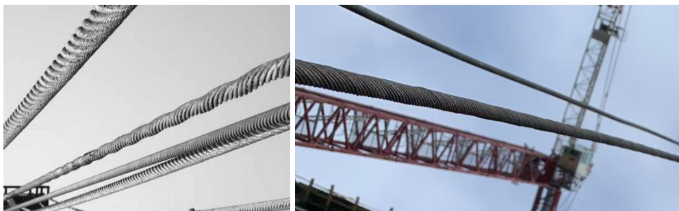
Рис. 2. Повреждение каната, деформация каната типа «штопор»
