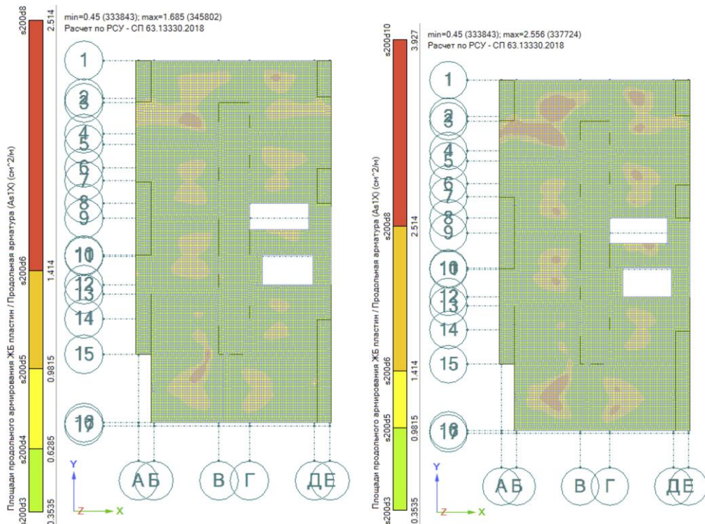
Рис. 11. Нижняя арматура (2-й ряд) в плите над 13-м этажом при применении линейного расчёта (слева) и при использовании режима «Монтаж» (справа), \text{см}^2/\text{м} .
