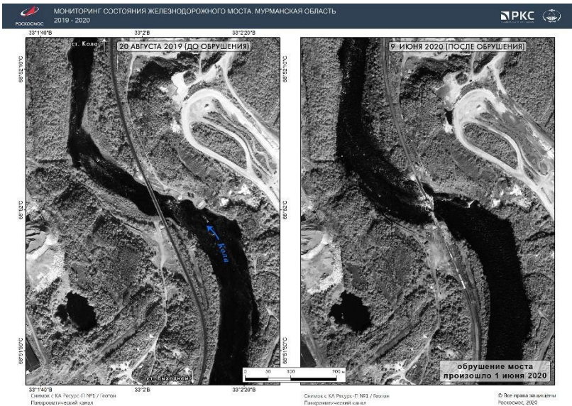
Рис. 2 – Мониторинг состояния железнодорожного моста с использованием данных космической съемки
