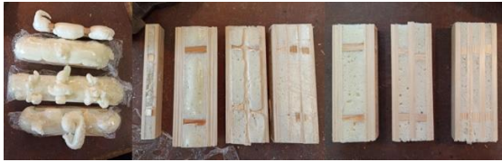
Рис. 5 - Изготовленные образцы термобрусов с разными вариантами «армирования»
