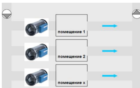
Рис. 1 – Схематичное изображение системы вентиляции с постоянным расходом воздуха (CAV)
