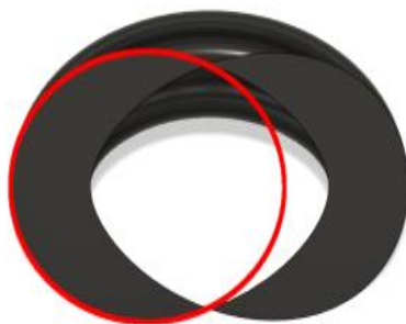
Рис. 6 – Сечение поверхности с плоской эллиптической линией центров одной из бикасательных плоскостей
