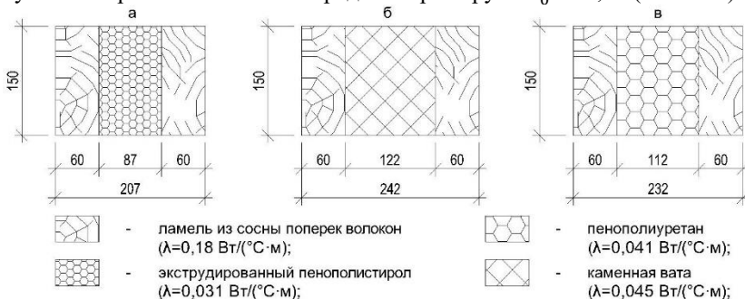
Рис. 3 - Результаты расчета термобруса с разными видами утеплителя: а – экструдированный пенополистирол, б – каменная вата, в – пенополиуретан
