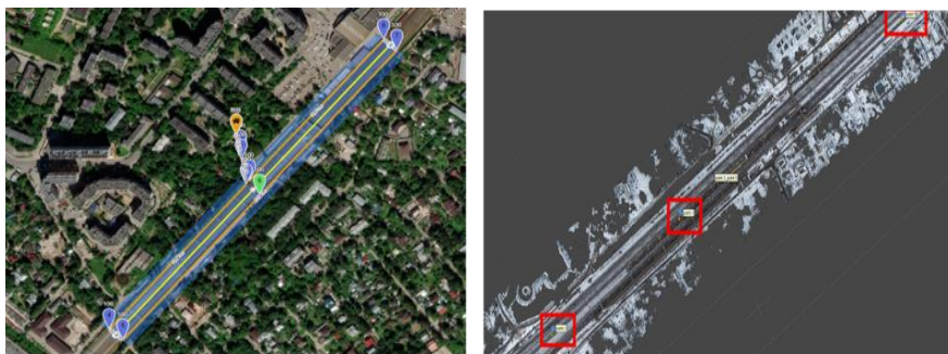
Рис. 2 – Построение фотограмметрической модели участка железнодорожного пути
