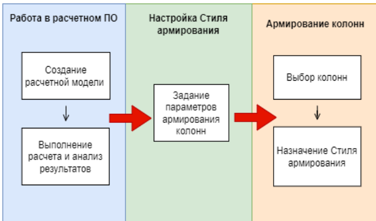
Рис. 5 – Алгоритм армирования типовых колонн в Renga
