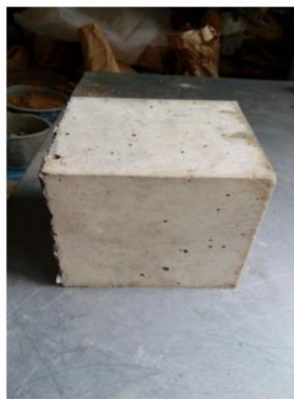
Рис. 1. Изменение состояния бетона за 2 года а) не модифицированного гидрозоле б) модифицированного гидрозоле.
