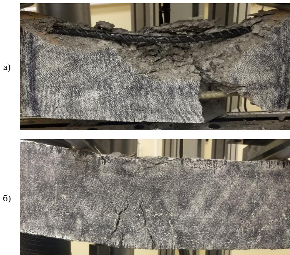
Рис. 3. Характерная схема разрушения опытных балок: (а) – образец серии Б, (б) – образец серии ПФБ
