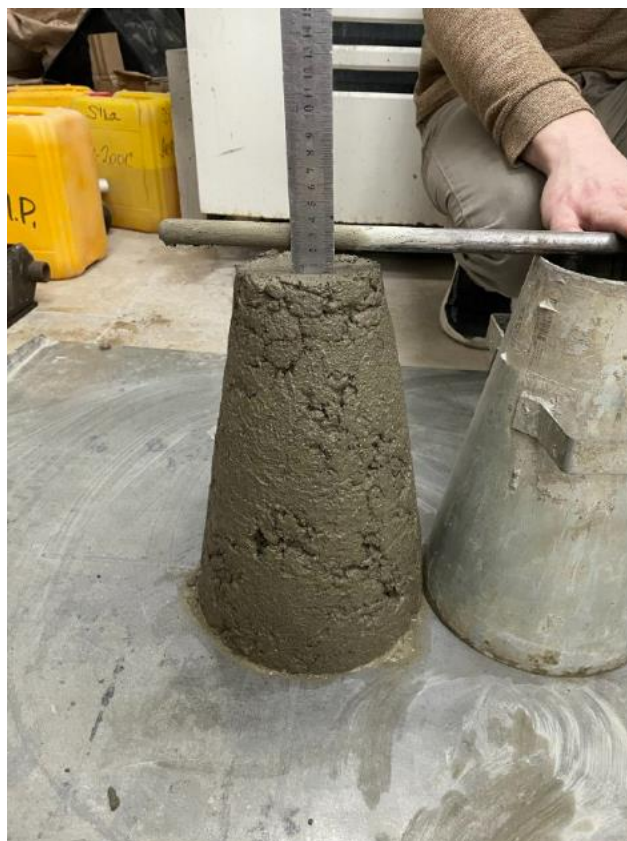
Рис. 3. Осадка конуса бетонной смеси рабочего состава
