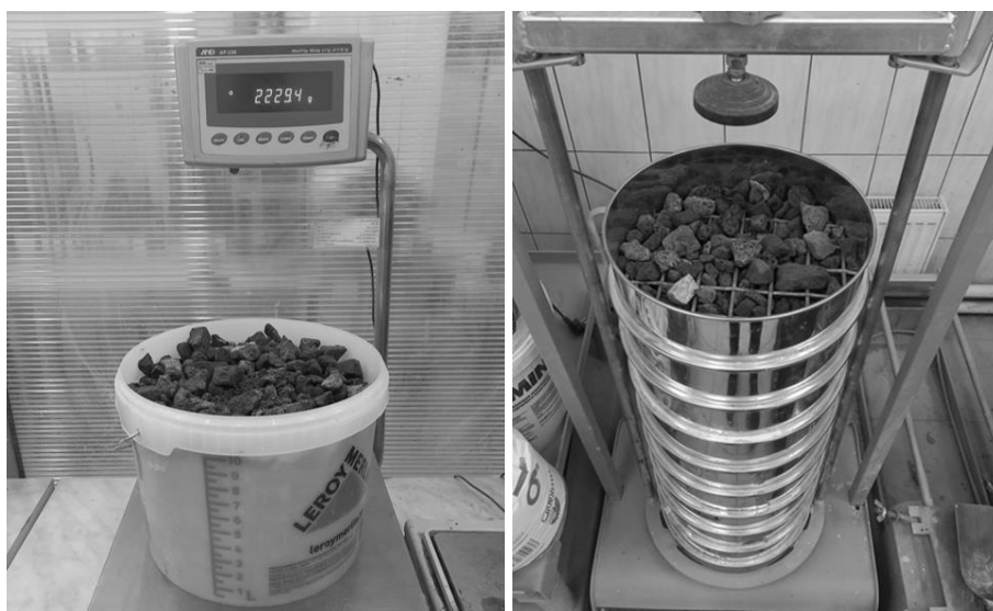
Рис. 2. Определение зернового состава пеностеклянного щебня
