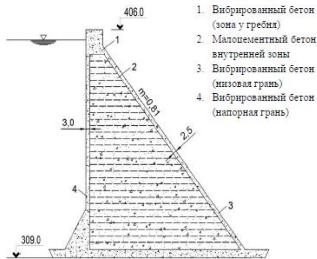
Рис. 1. Поперечное сечение глухой секции плотины
