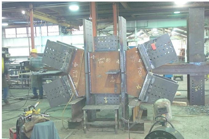
Рис. 2. Пример изготовления узла решетчатой сетки на производстве
