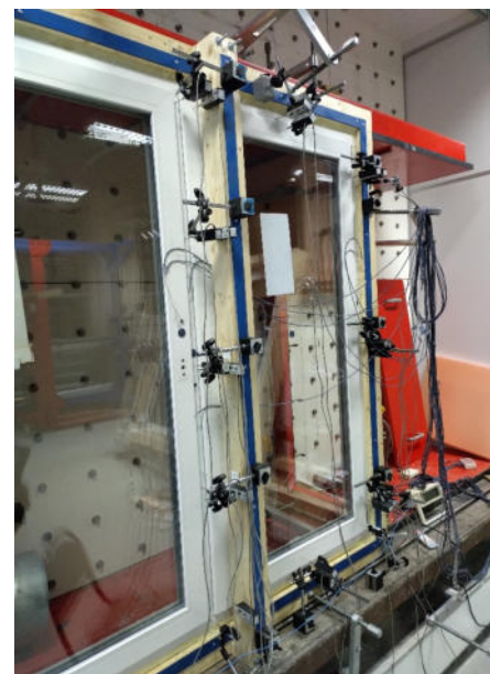
Рисунок 3.2 – Оконный блок SL70-18, установленный на испытательный стенд после монтажа всех датчиков
