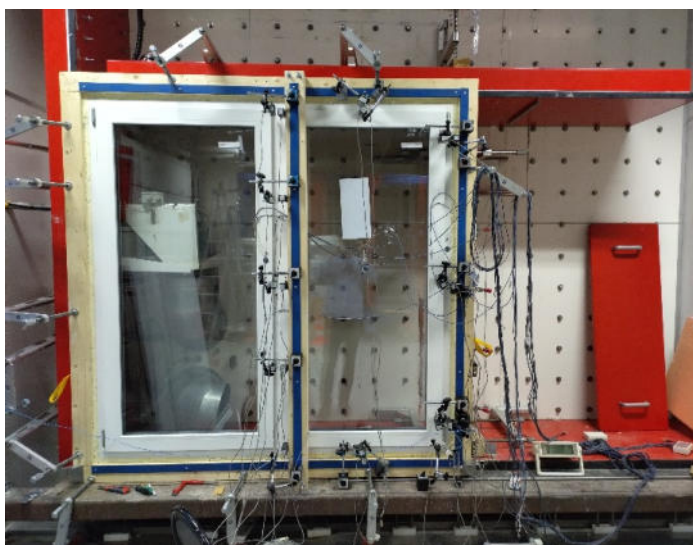
Рисунок 3.2 – Оконный блок SL70-18, установленный на испытательный стенд после монтажа всех датчиков
