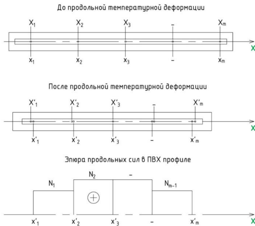
Рисунок 2.24 – Расчетная схема для определения продольных усилий в точках крепления
